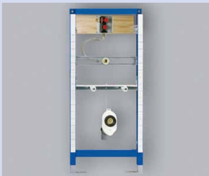
SANIT Urinal-Element 995 für UP- und AP-Spüleinrichtung vormontiert, mit Ablaufbogen DN 56 und Befestigungsmaterial
