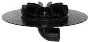
Akasion Dachablauf mit Schraubflansch nach EN 1253 für Dachentwässerung mit Druckströmung. Geeignet zur mechanischen Befestigung/Abdichtung der Dachabdichtungsbahn.
