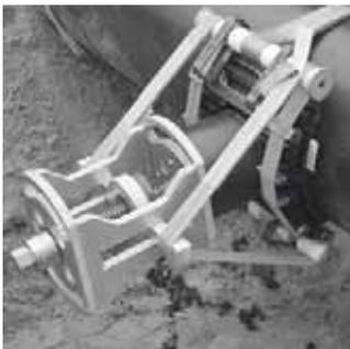
Zur Montage von FRIALEN Stutzenschellen SA UNI d 250 – d 900 mit Abgang d 90, d 110, d 125 und d 160 sowie von FRIAFIT Stutzenschellen ASA UNI d 630 - d 900 mit Abgang d 160 / SDR 17. Auslieferung in Transportkiste.
