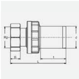
Übergangsadapter mit frei drehbarer Überwurfmutter, zur einfachen und schnellen Montage auf ein feststehendes Aussengewinde. Zum Einsatz im Wasserbereich. PE-Rohrstutzen SDR11. Länge des Abgangsstutzens für FRIALONG Muffen nicht geeignet.
