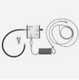
Alternativ zur Vakuumpumpe: Betrieb in Verbindung mit einem Baustellenkompressor. Zur Montage von FRIALEN XL Stutzenschellen SA XL mit Abgang d 160, d 225 und d 250, von FRIAFIT Abwassersätteln ASA VL mit Abgang d 225 sowie von FRIALEN XL Reparatursätteln RS XL. Bestehend aus VACUBOX XL, Manometer und Anschlussleitungen. Stecknippel NW 7,2 oder Klauenkupplung zum Anschluss am Baustellenkompressor. Auslieferung in Transportkiste.
