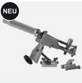
Zum sicheren Entfernen der Oxidschicht von PE-HD- und PE-Xa-Rohren. Schälmesser aus Hartmetall mit zweiter Schneide für doppelte Standzeit (lange Lebensdauer). Gleichmäßiger Spanabtrag durch federgelagertes Schälmesser und automatischen Vorschub. Mit Schnellverstellung zur einfachen Anpassung der Schällänge und wechselbarem Spannschlitten für die Dimensionen d 75-d 225 und d 250-d 400. Auslieferung in Transportkiste.
