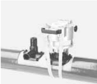
Zur Montage von FRIALEN XL Top-Loading Sattelformstücken ohne Unterschelle für alle Rohrdurchmesser im jeweils angegebenen Abmessungsbereich mit extra elastischer Pneumatikfederung und zum optimalen Fügedruckaufbau während der Schweißung. Auslieferung in Transportkiste.
