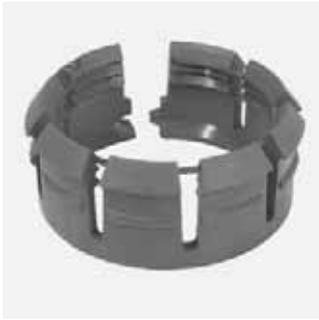
Spezialklemmring aus Acetal zum Einsatz von MAGNUM 3G-Klemmfittings auf Rohren aus PVC im Wasserbereich (d20-d63). Der Original-Klemmring muss durch PVCK ersetzt werden.
