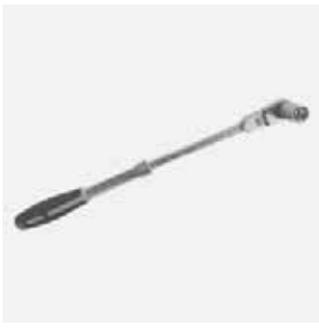
Zur Bohrerbetätigung der FRIALEN Druckenbohrarmaturen DAA mit Schnellspannhebel, bestehend aus Ratsche 1/2" teleskopierbar inklusive Steckschlüsselaufsatz SW17.
