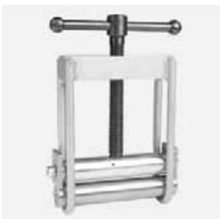
Manuelle Abquetschvorrichtung zum provisorischen Absperren von PE-HD- und PE-Xa-Rohren d 63 - d 125 in SDR 11 und SDR 17,6.
