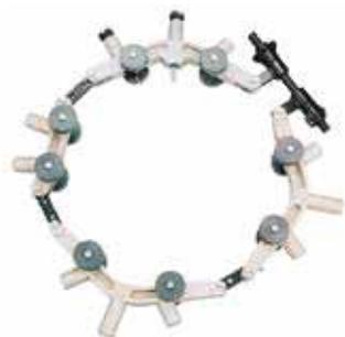
Rohrabschneider zum Trennen und Anfasen von PE-HD-Rohren d 160 – d 800 ist modular aufgebaut und besteht aus verschiedenen Gliedern, die je nach Kombination für unterschiedliche Rohrdurchmesser kombiniert werden können.
