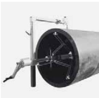
Zum sicheren Entfernen der Oxidschicht bei Grossrohren aus PE-HD im Nennweitenbereich von d 800 bis d 1200, SDR 11 - SDR 33. Modularer Aufbau für einfaches Handling und schnelle Montage. Nennweitenanpassung über Schnellverstellung. Mittig gelagerter Antrieb über Handkurbel. Automatischer Ausgleich von Rohrovalitäten und Toleranzen durch federgelagerte, einstellbare Messereinheit. Schälmesser ausgelegt als Wendemesser mit 2 Schneiden (hohe Lebensdauer). Auslieferung in Transportkiste.
