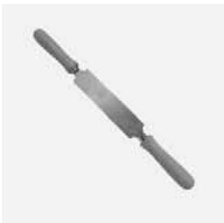
Zum Entfernen der Oxidschicht von PE-Grossrohren, die nicht durch entsprechende Schälgeräte bearbeitet werden können. Insbesondere zur Vorbereitung von Sattelflächen für die Verarbeitung von FRIALEN XL Sattelformstücken. Ebenso geeignet zum Entgraten von Schnittkanten. Mit zwei Schneidflächen.
