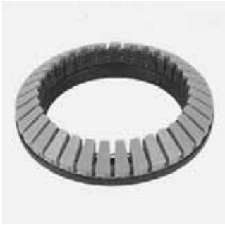
Komplettes Dichtsystem für FRIAGRIP-Formstücke. Bei mehrmaliger Verwendung eines Bauteiles ist für jede Anwendung ein neues Dichtsystem erforderlich. Das Dichtsystem besteht aus: Dichtung NBR bzw. EPDM, Haltesegmente Acetal, Greifsegmente Acetal korundbeschichtet.
