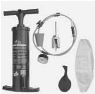
Reparaturset zum Rückhalten von nachlaufendem Restwasser bei der Durchführung von Reparatur- und Einbindungsarbeiten an PE-HD Wasserleitungen in den Dimensionen d 90 bis d 900. Bestehend aus Universal-Reparaturset mit Pumpe, Manometer, Bohrer und Anschlussschlauch sowie zusätzlich dimensionsbezogene Reparaturballons.
