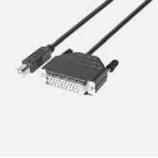
Zum Anschluss eines Druckers mit USB Typ B-Port an FRIAMAT Schweißgeräten ab Baujahr 2000 mit paralleler Schnittstelle. Ermöglicht das direkte Ausdrucken der Schweißdaten auf einem USB-Drucker (GDI-Drucker werden nicht unterstützt). Stromversorgung erfolgt über das mitgelieferte Netzteil. Adapter inklusive.
