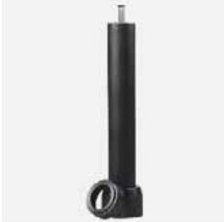
Starres Betätigungsgestänge aus Edelstahl zum zuverlässigen Bedienen der erdverlegten FRIALEN KH, KHP, KH-USTR, AKHP und AKHP-TL von der Strassenkappe aus. Schlüsselstange in 20 x 20 mm Vierkant-Ausführung mit PE-Schutzrohr zur schnellen Anpassung an die bauseits benötigte Rohrdeckung. Inklusive Adapter für Kugelhähne KH der Dimensionen d 50-d225. Korrosionssicher. PE-Schutzrohr mit Kuppelmuffe, Abschlusskappe aus PE und Zentrierscheibe aus Gummi.
