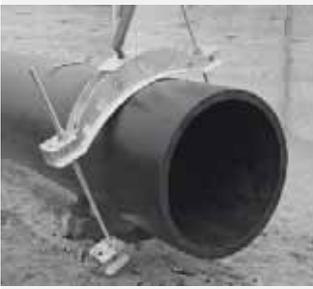
Zum Rückrunden von PE-HD-Rohren. Dimensionsübergreifend einsetzbar für Rohre d 800 – d 1200.
