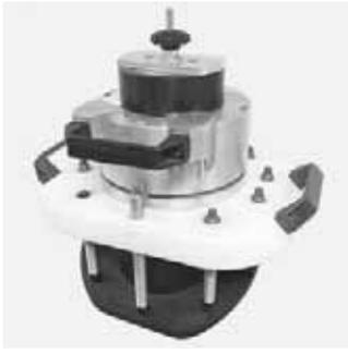
Aufspanngerät zur Verarbeitung von FRIAFIT Abwassersätteln ASA TL und Übergangssätteln ASA TL KG speziell bei PE-HD Close-Fit-Linern DN 200 - DN 500 und bei PE-HD Rohren d 630. Zum Aufspannen und Herstellen des notwendigen Fügedrucks bei der Schweißung. Bestehend aus ASATOP Spanngerät mit Kippdübel (ohne rohrumfassende Spanngurttechnik), Lochsäge (Ø 95 mm) mit SDS-Lochsägenaufnahme, Zentrierbohrer und Verlängerung sowie Druckluftpumpe. Auslieferung in Transportkiste.
