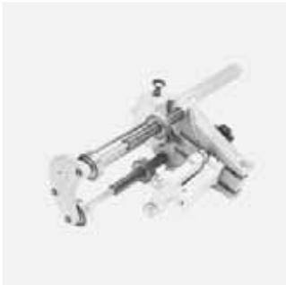
Zum sicheren Entfernen der Oxidschicht von Stutzenfittings. Zusätzlich ist das Schälen von PE-HD- und PE-Xa-Rohren möglich (maximal auf halber Muffenlänge d 710). Schälmesser aus Hartmetall für hohe Standzeit (lange Lebensdauer). Gleichmässiger Spanabtrag durch federgelagertes Schälmesser und automatischen Vorschub. Inklusive einem Ersatzschälmesser. Auslieferung in Transportkiste.
