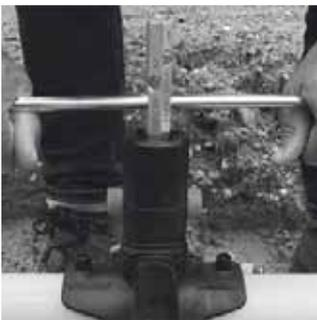
**FWSR T****Ratsche für Betätigungsschlüssel für Druckenbohrarmaturen mit Schnellspannhebel**
