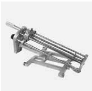
Zum sicheren Entfernen der Oxidschicht von PE-HD-Rohren auf halber oder ganzer Muffenlänge. Schälmesser aus Hartmetall für hohe Standzeit (lange Lebensdauer). Gleichmässiger Spanabtrag durch federgelagertes Schälmesser und automatischen Vorschub. Inklusive einem Ersatzschälmesser. Auslieferung in Transportkiste.
